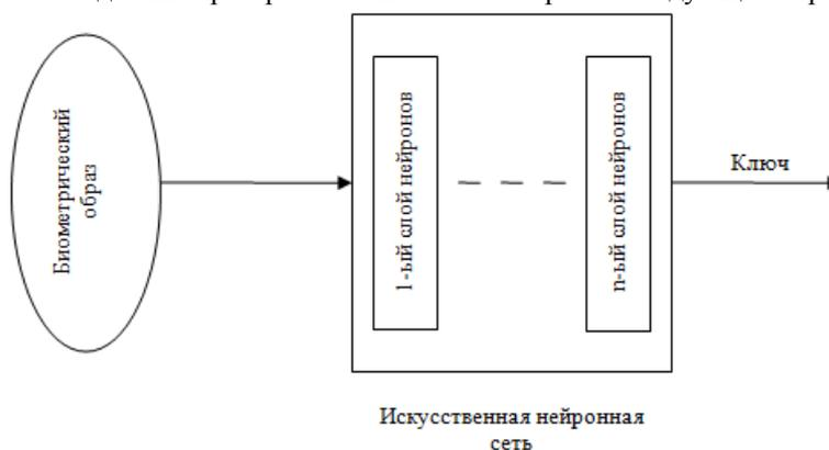
Рисунок. Схема нейросетевого преобразователя «биометрия-код доступа»
